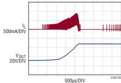
**Figure 3. Soft-Start Waveforms**
