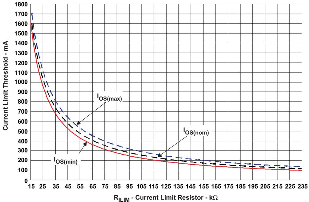
Figure 24. Current-Limit Threshold vs R<sub>ILIM</sub>
