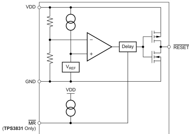
Figure 2. TPS383x Block Diagram
